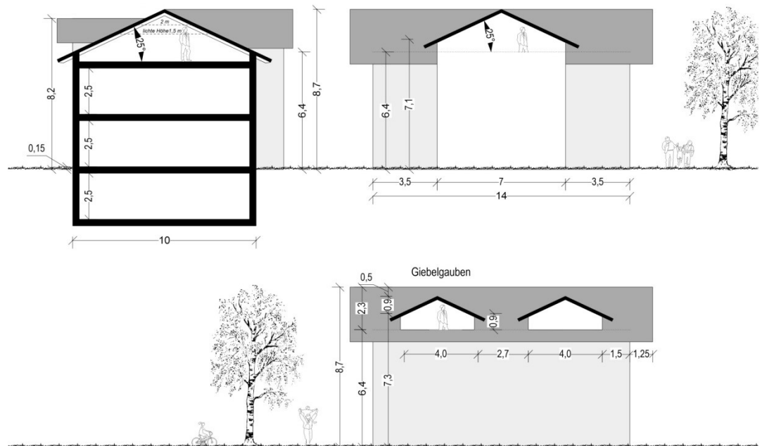
Abb. 24 Schnitt und Schemaansichten mit Dachaufbauten (Quergiebel und Gauben) bei einer Dachneigung von 25°, ohne Maßstab
